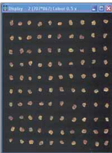
Figura 51 - Immagine standardizzata. Questa operazione consente di ottenere risultati sovrapponibili per il colore, utilizzando qualsiasi tipo di scanner. (foto: G. Venora)
