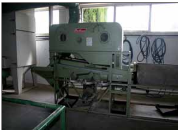
Figura 18 - Macchina a flusso d'aria e con cilindro dentato per la separazione dei semi del CNNGF El Serranillo. (foto: A. Prada)
